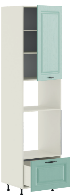
ПДМ-600_Н10 (600 x 2425 x 570 мм) место под духовой шкаф (Д.566 x В.590 x Г.554 мм) место под микроволновку (Д.566 x В.380 x Г.554 мм)
